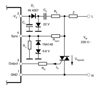
$C_1 = 100 \,\mu\text{F}/35 \,\text{V}$
