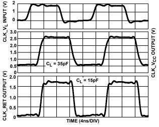
FIGURE 21. ISL3035E CLOCK WAVEFORMS (100Mbps)
