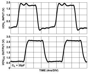
FIGURE 19. I/OV<sub>CC</sub> OUTPUT WAVEFORMS (100Mbps)
