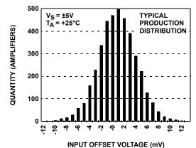
FIGURE 1. INPUT OFFSET VOLTAGE DISTRIBUTION
