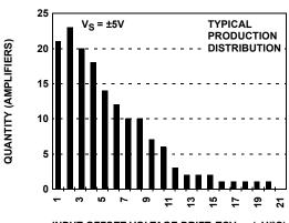
INPUT OFFSET VOLTAGE DRIFT, TCV<sub>OS</sub> ( $\mu$ V/°C) FIGURE 2. INPUT OFFSET VOLTAGE DRIFT
