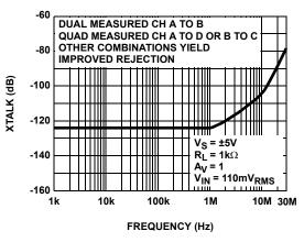
**FIGURE 22. CHANNEL SEPARATION**
