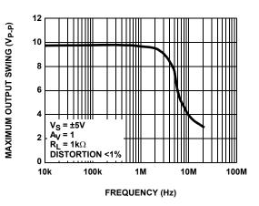
FIGURE 18. MAXIMUM OUTPUT SWING vs FREQUENCY
