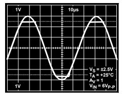
FIGURE 28. OPERATION WITH BEYOND-THE-RAILS INPUT
