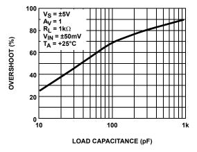
FIGURE 23. SMALL-SIGNAL OVERSHOOT vs LOAD CAPACITANCE
