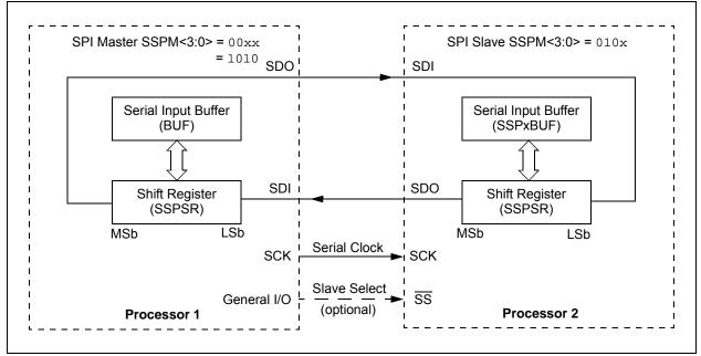
FIGURE 24-5: SPI MASTER/SLAVE CONNECTION
